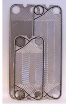
m2/DN 100/4") FPG 60 (0,6 m2/DN 150/6") FPG 70 (0,7 m2/DN 200/8") Пластины типа FPG представляют собой две пластины, сваренные при помощи лазерной сварки в «кассету». Между пластинами образован герметичный канал для протекания агрессивной среды. На «стороне воды» (между кассетами) для герметичности используются стандартные уплотнения. Толщина пластин серии FPG составляет 0,6 мм.
