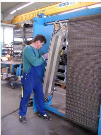
Рис 6.4. Демонтаж пластины с нижней направляющей.
