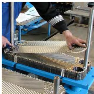
Рис 6.13. Сборка маленьких типоразмеров теплообменников
