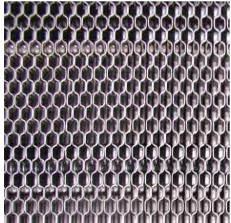
Рис 6.14. Торцевая сторона пакета пластин
