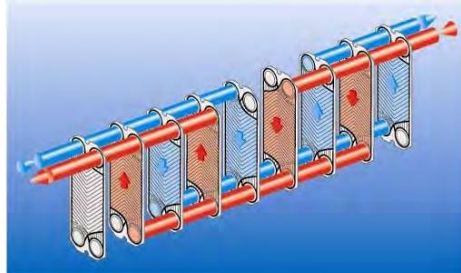
Рисунок 3.3. Многоходовая схема
