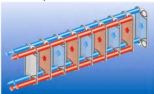
Рисунок 3.2. Одноходовая схема.
