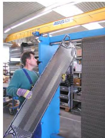
Рис 6.5. Демонтаж пластины с верхней направляющей.
