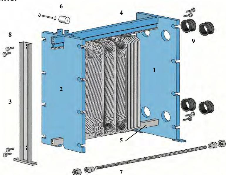
Рисунок 3.1. Конструкция теплообменника
