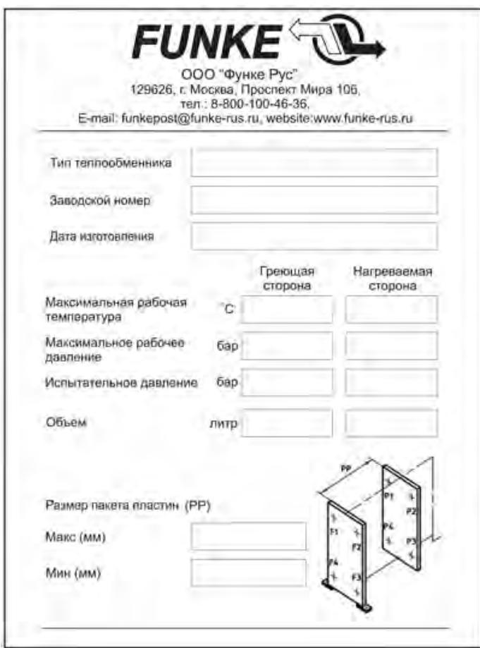
Рисунок 1.1 Принципиальная компоновка типового шильда
