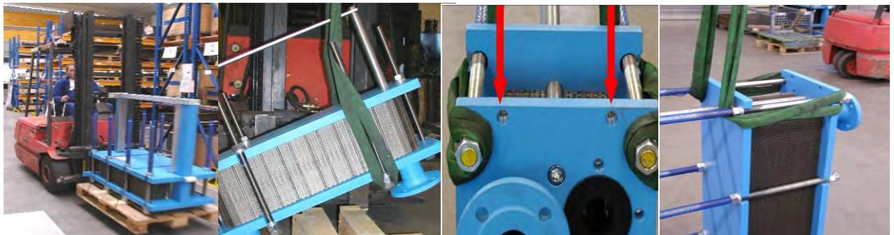
Рисунок 4.1. Транспортирование погрузчиком
