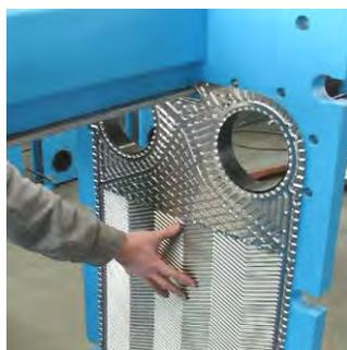
Рис 6.11. Монтаж первой пластины
