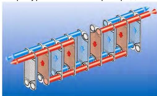
Рисунок 3.3. Многоходовая схема
