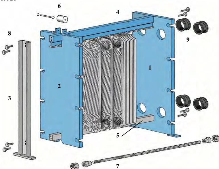
Рисунок 3.1. Конструкция теплообменника
