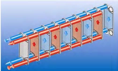
Рисунок 3.2. Одноходовая схема.
