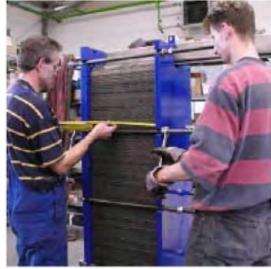
Рис 6.3: Правильный порядок вскрытия ПТО с контролем допустимого перекоса нажимной плиты.
