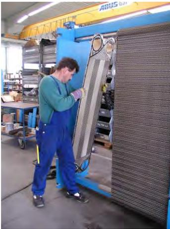
Рис 6.4. Демонтаж пластины с нижней направляющей.
