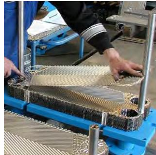
Рис 6.13. Сборка маленьких типоразмеров теплообменников
