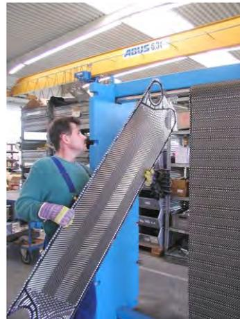
Рис 6.5. Демонтаж пластины с верхней направляющей.
