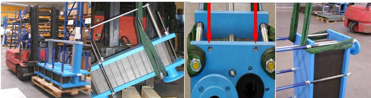
Рисунок 4.1. Транспортирование погрузчиком
