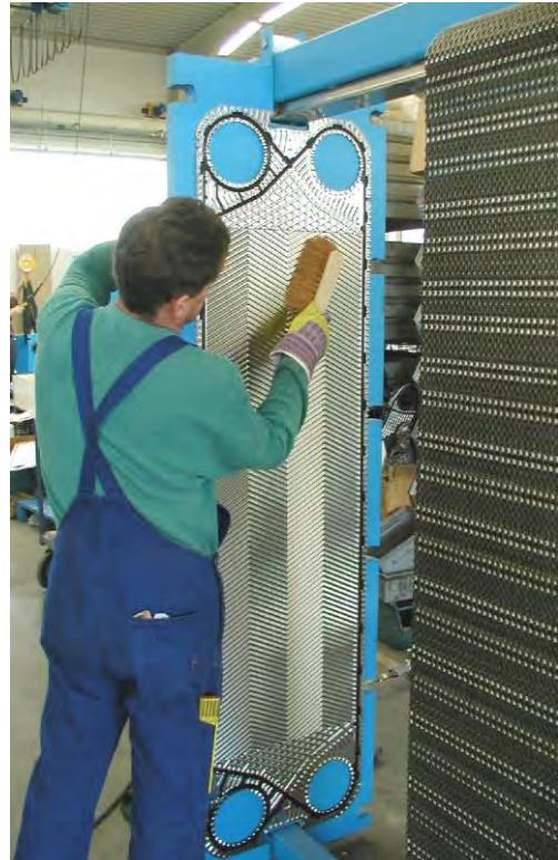
Рисунок 6.6. Очистка поверхности пластины с помощью мягкой щетки.
