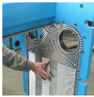
Рис 6.11. Монтаж первой пластины
