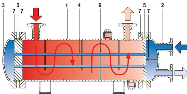
Тем не менее, эффективный теплообмен обеспечивается только при достаточной разности температур. Чем выше разность температур, тем меньше требуемая площадь поверхности теплообмена. Тепловая мощность теплообменника является функцией средне-логарифмической разности температур, площади поверхности теплообмена и коэффициента теплообмена. Причем последний определяется характеристиками потоков сред, т. е. геометрической конфигурацией аппарата.
