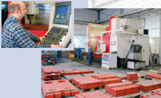
Установка CNC для производства корпусов ПТО
