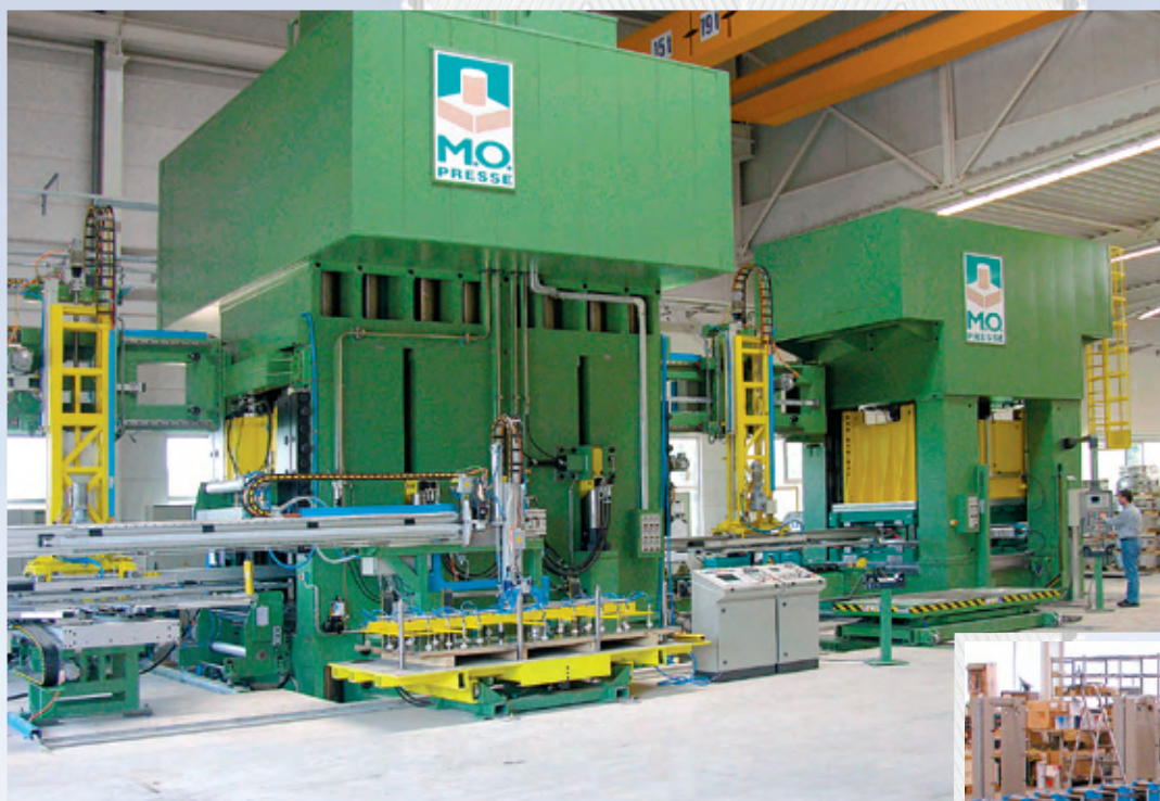
Полностью автоматический пресс мощностью 15.000 т. для производства больших типоразмеров пластин при использовании различных матриц
