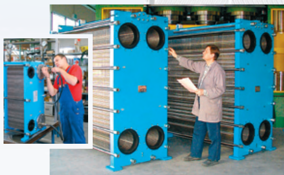
Гидравлическая опрессовка и конечный визуальный контроль являются завершительным этапом сборки теплообменников
