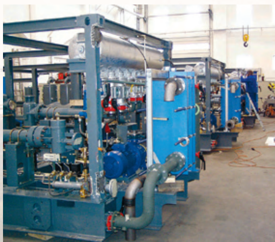
Охладитель в высоконапорных установках
