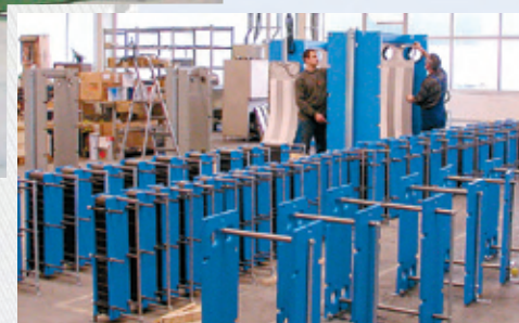
Участок конечной сборки малогабаритных и средних аппаратов
